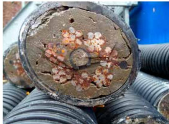
Litzenanker im Querschnitt
