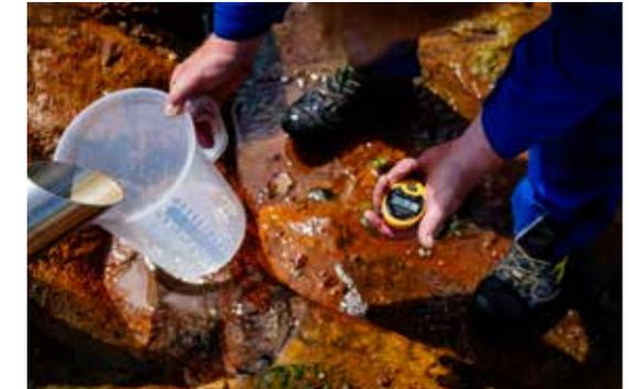
manuelle Sickerwassermessung der Dammdrainage
